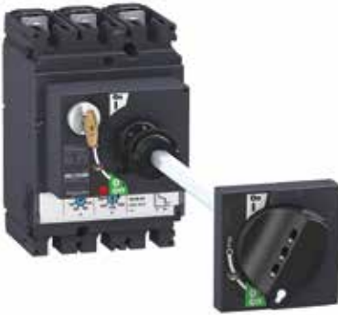
Compact NSX с выносной поворотной рукояткой. На лицевой панели установленного в глубине щита аппарата – дополнительный встроенный замок с ключом
